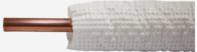
**CLIMATECH** est un tube en cuivre de distribution de fluides frigorigènes dans les domaines de la climatisation, du conditionnement d'air et des installations frigorifiques. Ce tube en cuivre sans soudure, **Recuit**, pré-isolé en usine, offre une solution fiable et efficace pour vos besoins de distribution. Le tube cuivre **CLIMATECH** clim se distingue par son état de surface interne impeccable, dégraissé et propre. Il est désoxydé au phosphore, conformément aux norme **EN 12735-1**.
